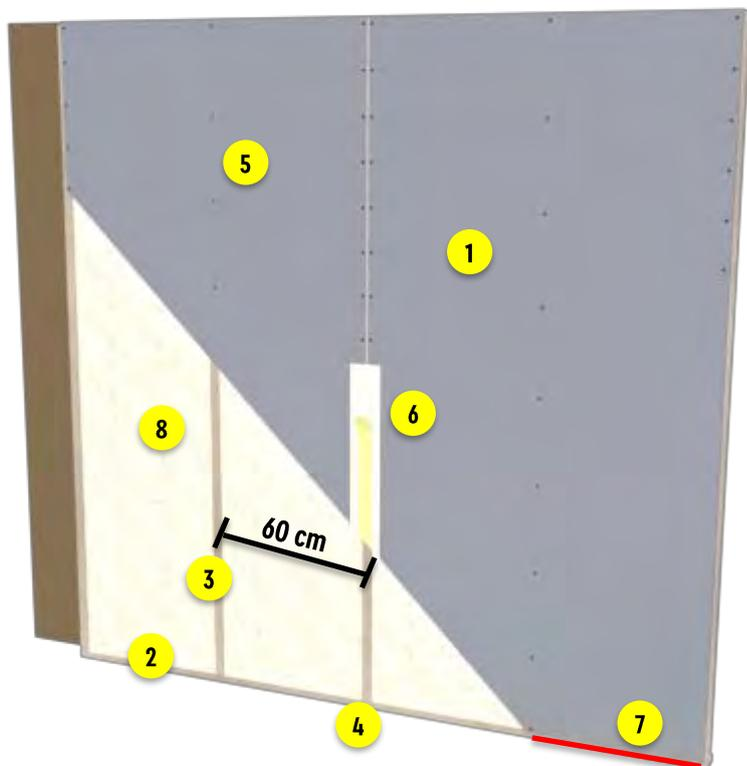
Pared interior compuesta por una estructura metálica sobre la cual se atornilla una capa de placas Durlock® ACU 60 por cara. Dentro de la cámara interior de 70mm se podrá colocar Lana de Poliester
