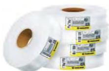
**Cinta de papel:** De celulosa, microperforada, de 50mm de ancho y premarcada en el centro. Se utiliza el tomado de juntas entre placas y para resolver ángulos formados por dos superficies construidas con placas Durlock®.
